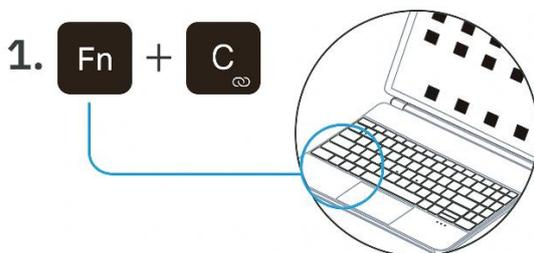
Mettez le clavier sous tension, puis appuyez sur les touches Fn+C du clavier. Le clavier sera dans un   tat de recherche en attente pendant trois minutes.
